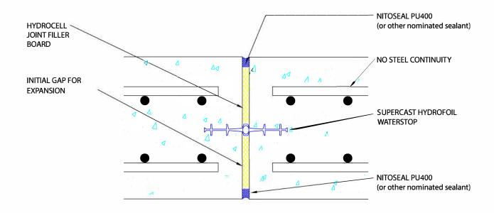
TYPICAL WALL EXPANSION JOINT DETAIL
